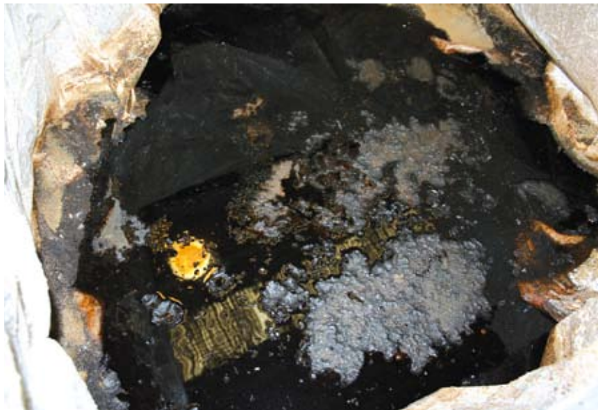
8 - Un dettaglio della fase di cristallizzazione del concentrato a temperatura ambiente. Il composto viene poi miscelato con le ceneri della pirolisi che assorbono l'acqua fangosa residua dalla cristallizzazione. Ciò consente di smaltire il concentrato come rifiuto solido speciale.
