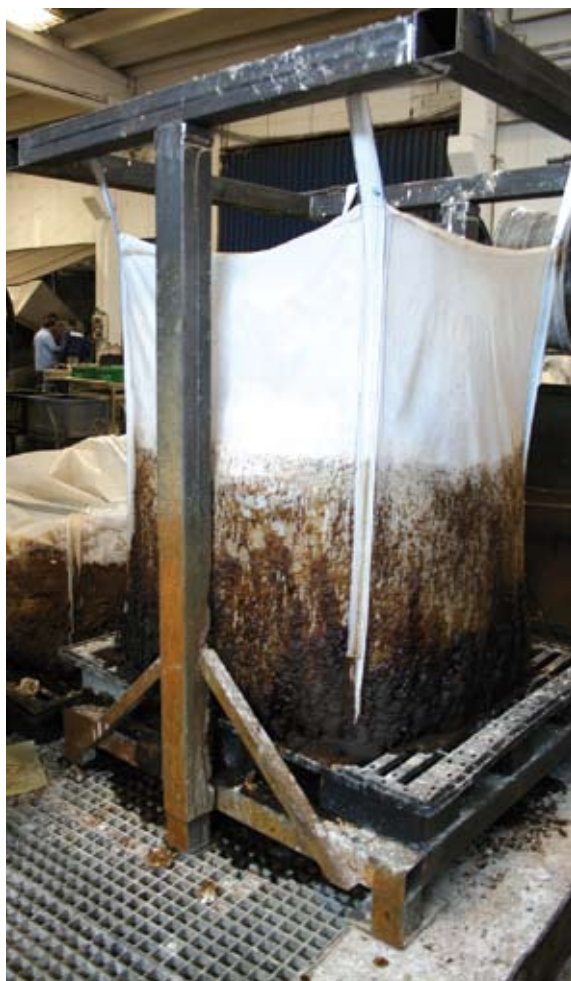
7 - Il big bag dove viene scaricato il concentrato in uscita dall'evaporatore dopo che l'acqua è stata filtrata, depurata e ricircolata nell'impianto. E' ben visibile la cristallizzazione quasi totale del concentrato che si trasuda dalle maglie del big bag.
