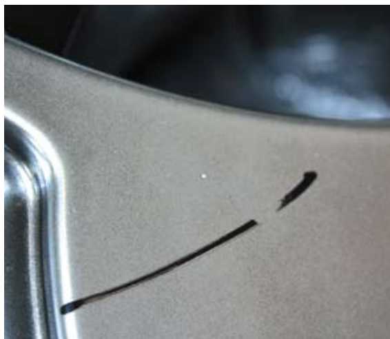
5 - Particolare di cerchio in lega con un difetto di verniciatura che ne compromette la qualità estetica finale. Un'altissima percentuale di cerchi sverniciati da Abl derivano da difetti di produzione.
